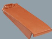
Dachówka szczytowa lewa 1/2 Waga: ok. 3,1 kg Zapotrzebowanie: 2,7 szt./mb Paleta: 100 szt.
