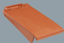
Dachówka szczytowa lewa Waga: ok. 5,1 kg Zapotrzebowanie: 2,7 szt./mb Paleta: 44 szt.
