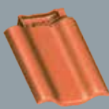
Dachówka dwufalowa Waga: ok. 3,2 kg Szer. krycia: 19,5 cm Dł. krycia: 33,0 – 36,0 cm Paleta: 90 szt.
