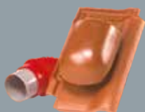
Ceramiczny komplet wentylacyjny Waga: ok. 8,3 kg Średnica wewnętrzna: 10,5 cm
