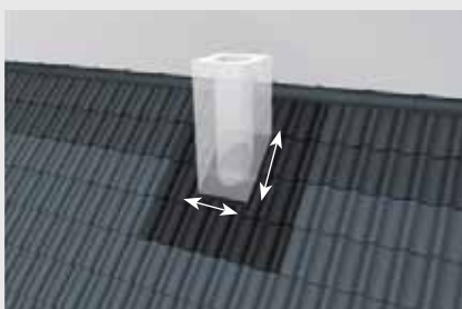
Połączenie połaci dachowej z kominem
