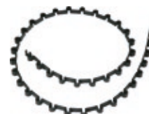
Mocowanie przewodów grzejnych w rynnach kwadratowych
