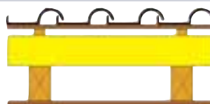
LINITHERM PAL Polimer na krokwiach, deskowanie pod krokwiemi.
