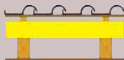
LINITHERM PAL N+F na krokwiach, płytach gipsowo-kartonowych lub deskowaniu drewnianym pod krokwiemi
